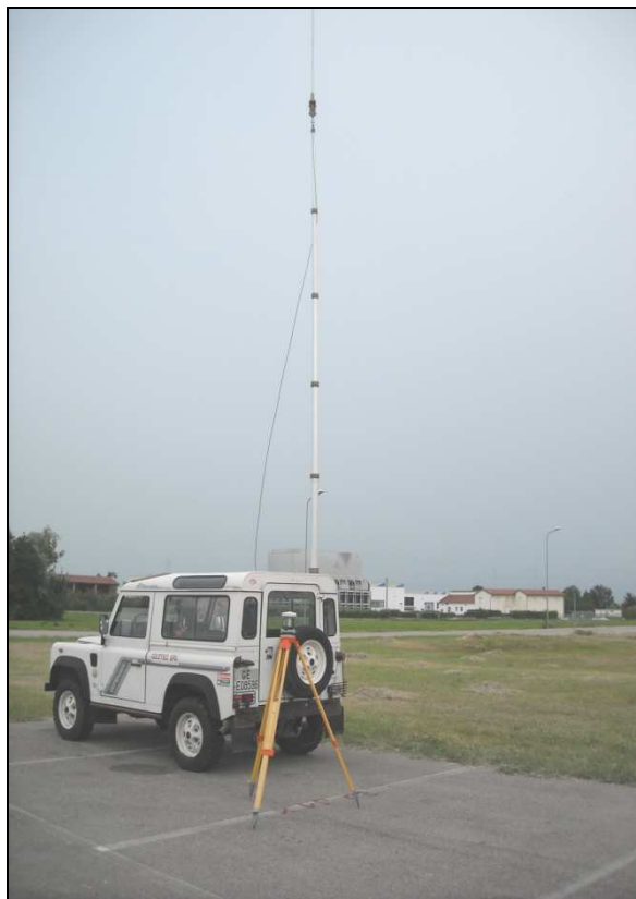
Base G.P.S. e ripetitore radio montato su un'antenna telescopica
